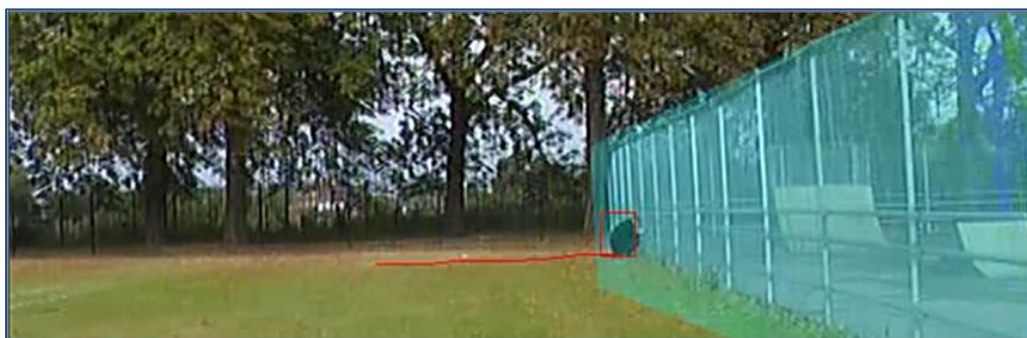
<< フェンス沿いの探知エリアと侵入探知 >>
